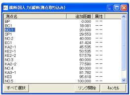
② 複数の測点を選択したい場合は、キーボードの[Ctrl]キー、または [Shift]キーを押しながら、測点を選択します。選択した測点は青色で表示されます。
