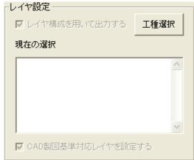
⑤ 「工種選択」画面を表示します。 P86「レイヤ設定ウィザードについて」を参照し、レイヤの設定を行ってください。
