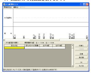
③ 「変化点名」列には、横断勾配が変化する測点を入力します。 「変化点からの距離」列には、入力した変化点名からの距離を入力します。
