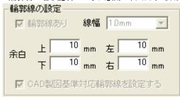
「線幅」枠から、出力する用紙の線の線幅を選択します。この線幅は、 横断図の全ての線に反映されます。
