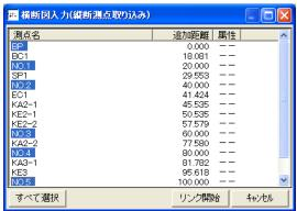
② 選択した測点をデータリンクし、横断図の変化点として「横断図入力(変化点登録)」画面に表示します。
