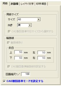
⑤ 「用紙サイズ」枠から、出力する用紙のサイズと、用紙の縦横方向を設定します。
