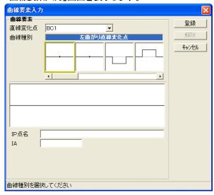
③ 「直線変化点名」欄に、曲線の開始位置の測点名が表示されていることを確認します。
