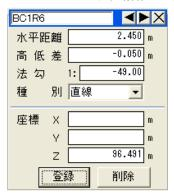
④ 登録した幅杭点情報を削除し、選択した点は幅杭点から解除されます。
