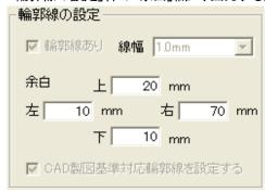
⑧ 「線幅」枠から、出力する用紙の線の線幅を選択します。この線幅は、 用紙の輪郭線や縦断図の線など全ての線に反映されます。
